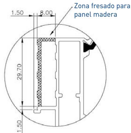
Ejemplo mecanizando la parte exterior del perfil, permitiendo la instalación de paneles hasta 9,5 cm (tipo fenólico, composite...)
